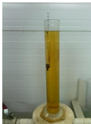
Рис. 3. Замер плотности насыщенного метанол при помощи ареометра АНТ-2 по ГОСТ 18481-81
