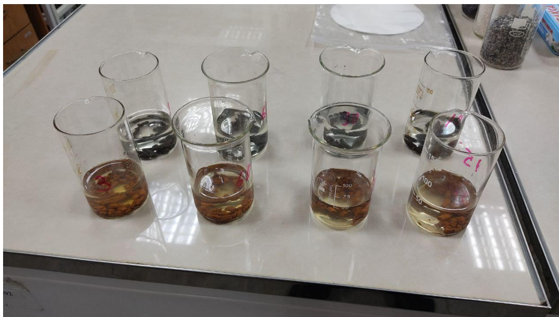
Рис. 4. Определение степени извлечения нефтепродуктов гранулированного сорбента на базе осадка СОПВ
