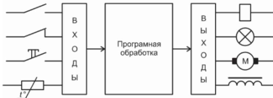
Рис. 1. Принцип работы цифрового программируемого реле
