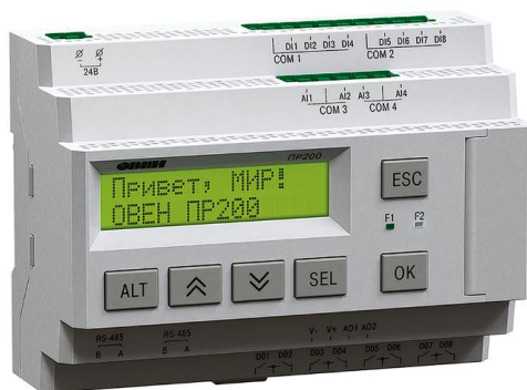
Рис. 2. Цифровое программируемое реле марки ОВЕН ПР200
