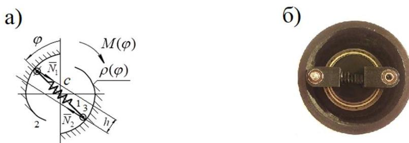
а) схема упругого шарнира, в котором пружина сжимается;
