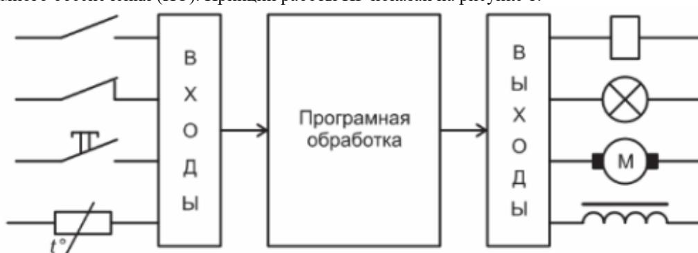
Рис. 1. Принцип работы программируемого реле
